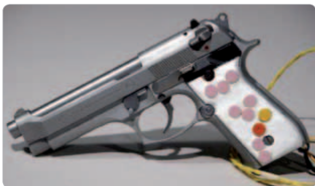
Obr. 41 Biodynamický identifikátor uchopení a stisku střelné zbraně
